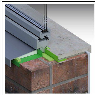
2. Bild: Lösungsmöglichkeit: Innen: ME500 | Mitte: FM230 | Außen: TP600 - ME500 - SP025 - SP525 - mit PR102
